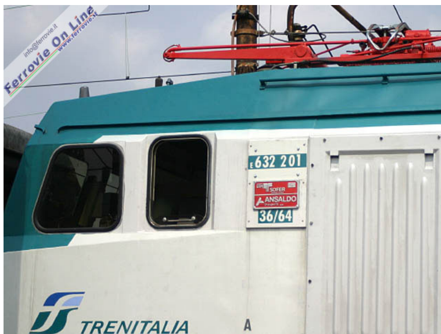
2 In mancanza di targhe appropriate sulla E.632.201 sono stati applicati adesivi per indicare la nuova numerazione ed il nuovo rapporto di trasmissione. (Foto Enzo Tomasello, 25 agosto 2005)
