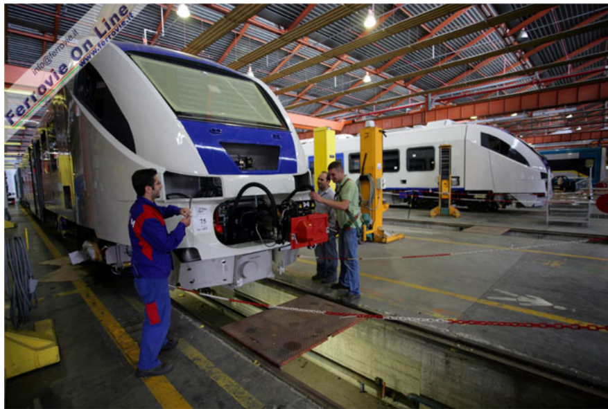
4. Linea di assemblaggio dei TTR per il GTT, nello Stabilimento ALSTOM di Savigliano. Foto Michele d'Ottavio/GTT, 19 settembre 2005
