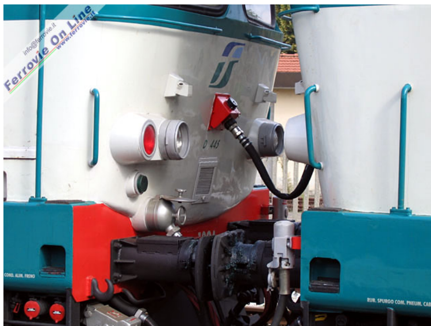
2 a Particolare dell'accoppiatore e condotta per il comando multiplo, tra la D.445.1093 e la D.445.1094. (Foto Giancarlo Scolari, 22 ottobre 2005)
