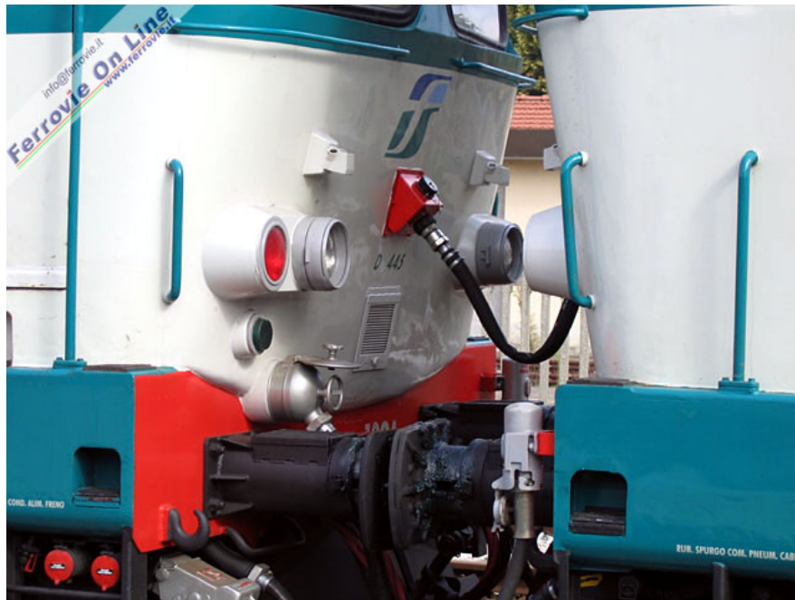
22 Particolare dell'accoppiatore e condotta per il comando multiplo, tra la D.445.1093 e la D.445.1094. Foto Giancarlo Scolari, 22 ottobre 2005
