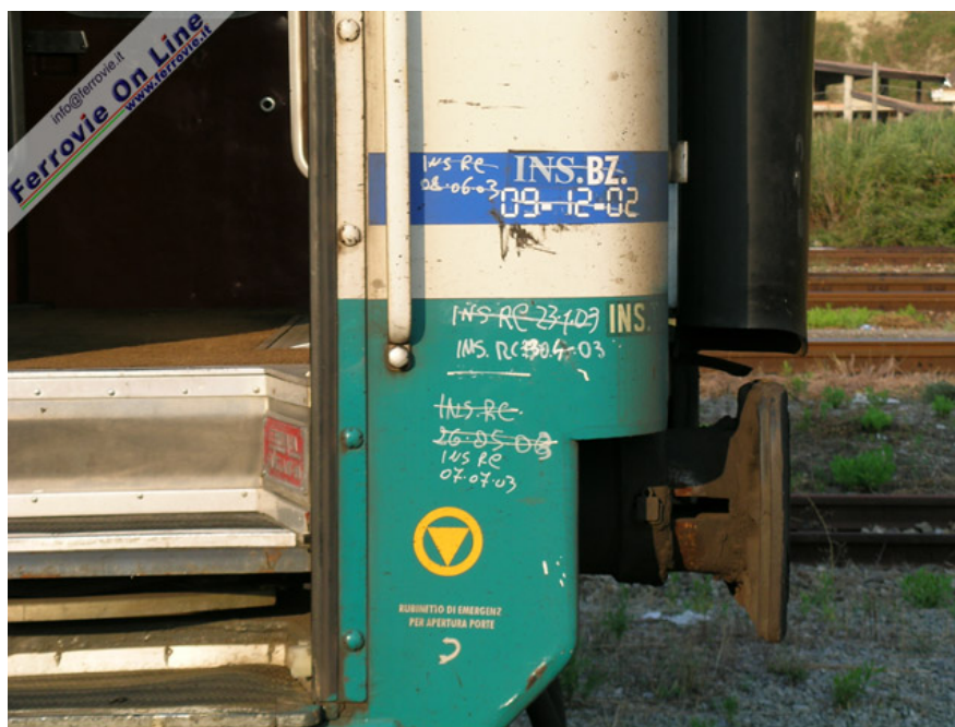
2, Dove non presente l'apposita etichetta adesiva, l'ultimo intervento di disinfestazione viene riportato con numeri adesivi o più di frequente a pennarello, direttamente sulla cassa della vettura barrando la data precedente. L'antiestetico risultato è ben visibile su questa carrozza Gran Confort a Cosenza. (Foto David Campione, 9 agosto 2003)
