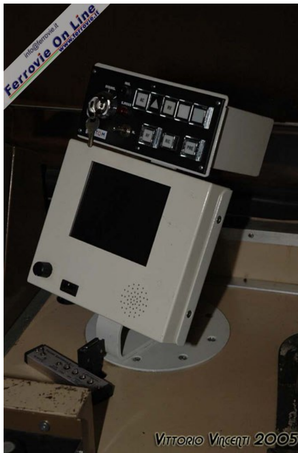
2, Apparato per la ripetizione segnali FS e localizzatore GPS della FCU, in opera sul banco di manovra di una ALn 776 della Seatrain. (Foto Vittorio Vincenti, 8 dicembre 2005)
