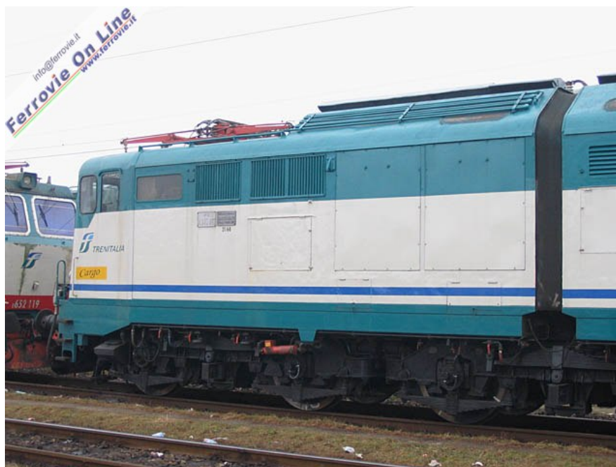
2. Un particolare della fiancata della E.645.366 lato apparecchiature, con i vistosi pannelli applicati in seguito alle modifiche interne. Foto Luca Catasta, 19 febbraio 2006
