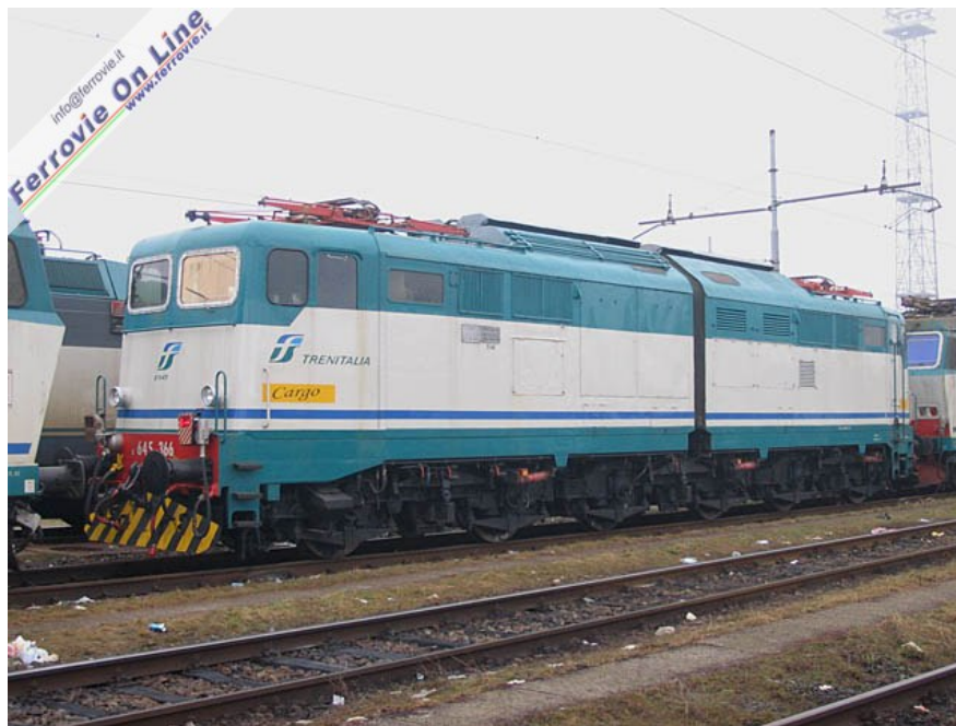
1. La E.646.066 dopo la RO eseguita a Foligno e la successiva trasformazione in E.645.366, ripresa in sosta nel deposito di Milano Smistamento. Foto Luca Catasta, 19 febbraio 2006
