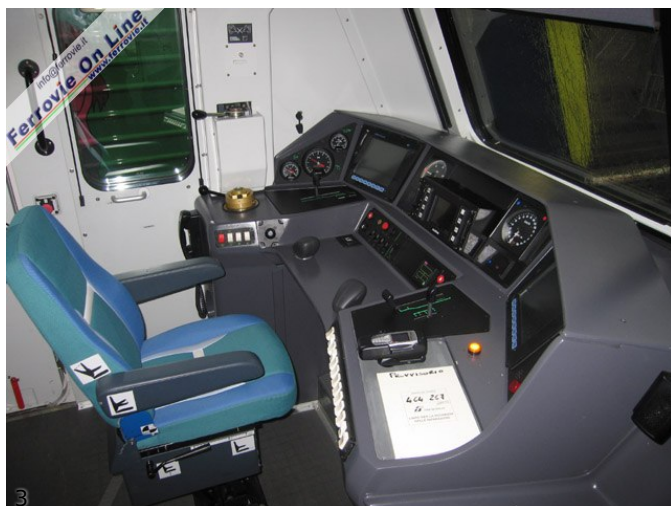
3. Vista d'insieme del banco di manovra della E.464.267. A destra nella foto l'altoparlante del viva voce, al centro il supporto veicolare per il cellulare e sulla parete alla sinistra del macchinista il microfono per lo stesso apparato.
