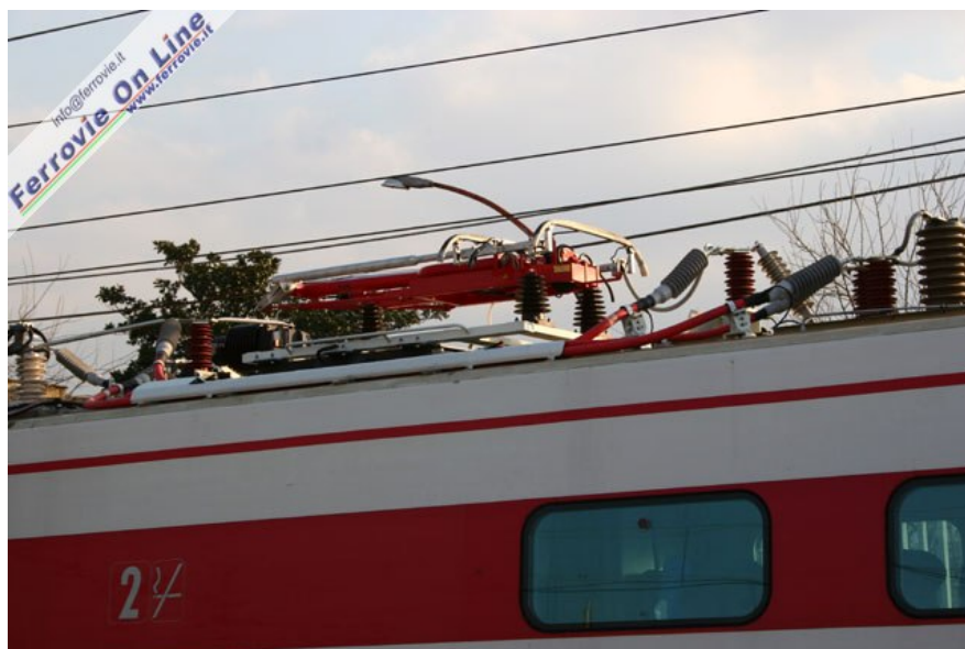
2. Particolare del pantografo ATR 95 sull'ETR.480 numero 42, appena uscito dallo stabilimento Firema di Caserta al termine della trasformazione per renderlo effettivamente politensione. (Foto David Campione, 5 gennaio 2005)
