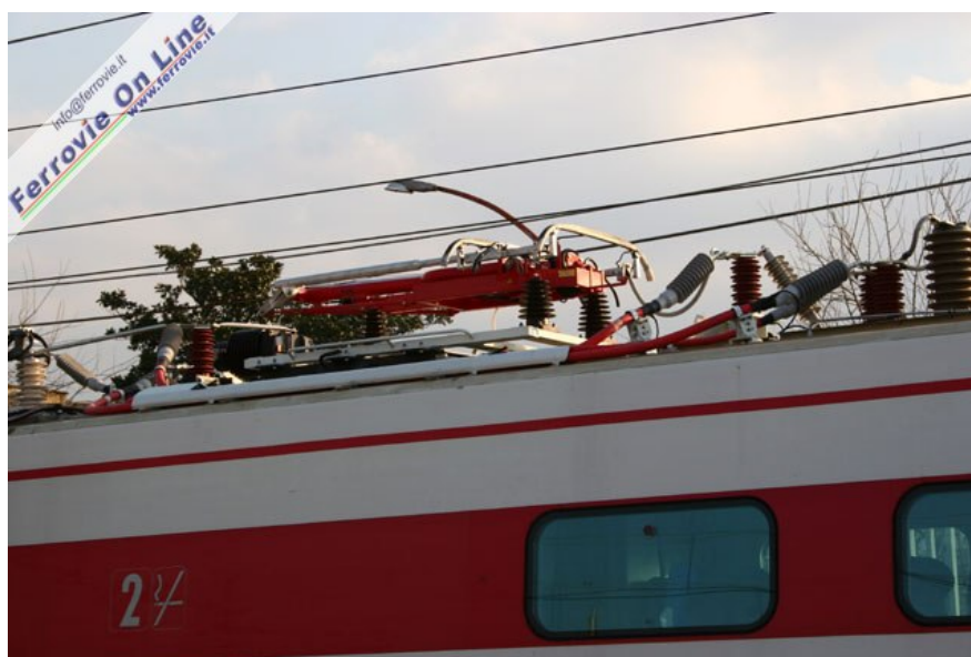
2, Particolare del pantografo ATR 95 sull'ETR.480 numero 42, appena uscito dallo stabilimento Firema di Caserta al termine della trasformazione per renderlo effettivamente politemperatura. (Foto David Campione, 5 gennaio 2005)
