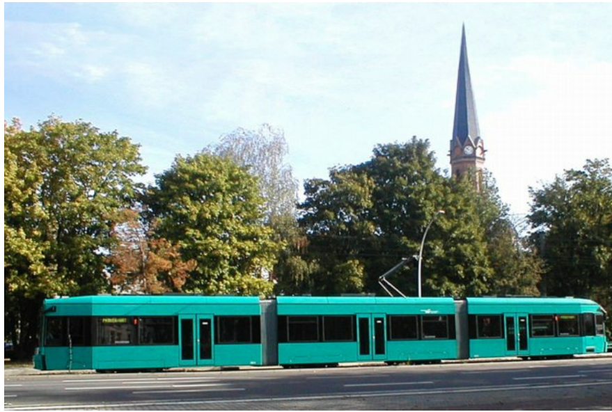
24 Il FLEXY Classic è un tram a piano ribassato di Bombardier già in esercizio dall'ottobre 2003. (Foto Bombardier, 16 ottobre 2003)
