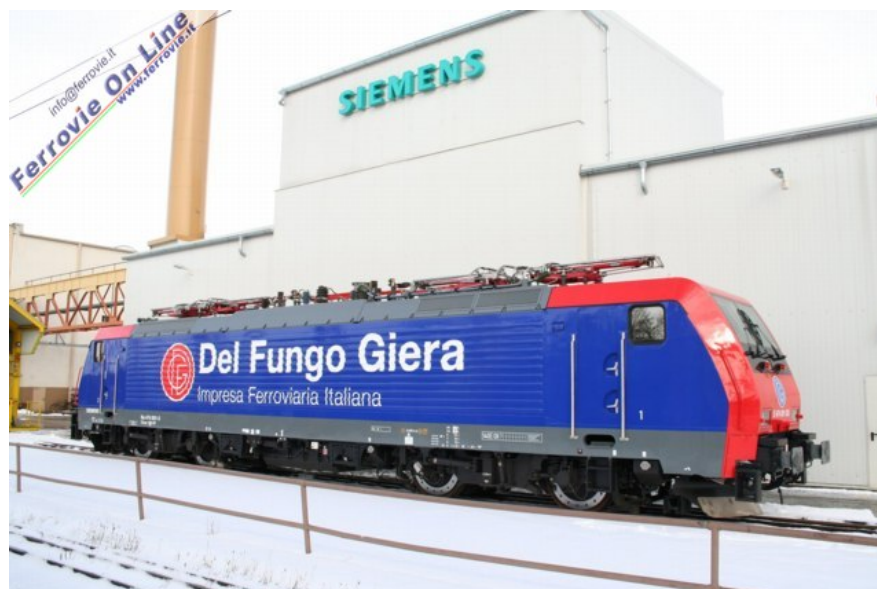
La nuova locomotiva E.474.001 in stabilimento, pronta per la consegna a Del Fungo Giera (Foto SIEMENS, 3 marzo 2006)
