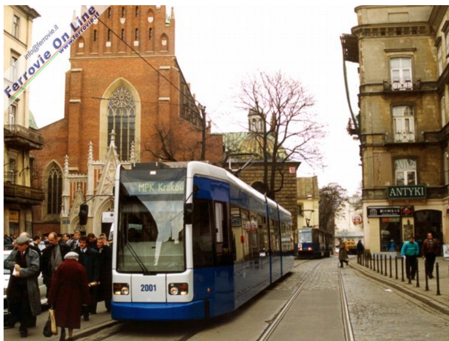
Il tram 2001, tipo Flexity classic a piano ribassato e capostipite di questa serie in via di espansione, in servizio per le strade del centro di Cracovia. (Foto Bombardier, 6 novembre 2001)
