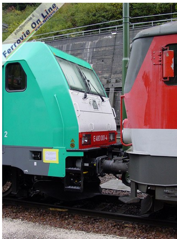
La E.483.001-4 appena giunta in stazione a Brennero in composizione ad un convoglio merci ordinario. La locomotiva è posizionata subito dietro le due macchine ÖBB titolari del treno. In evidenza il foglio fissato con nastro adesivo giallo riportante il divieto di separare la locomotiva dal carro scudo. (Foto Fabio Veronesi, 14 ottobre 2006)
