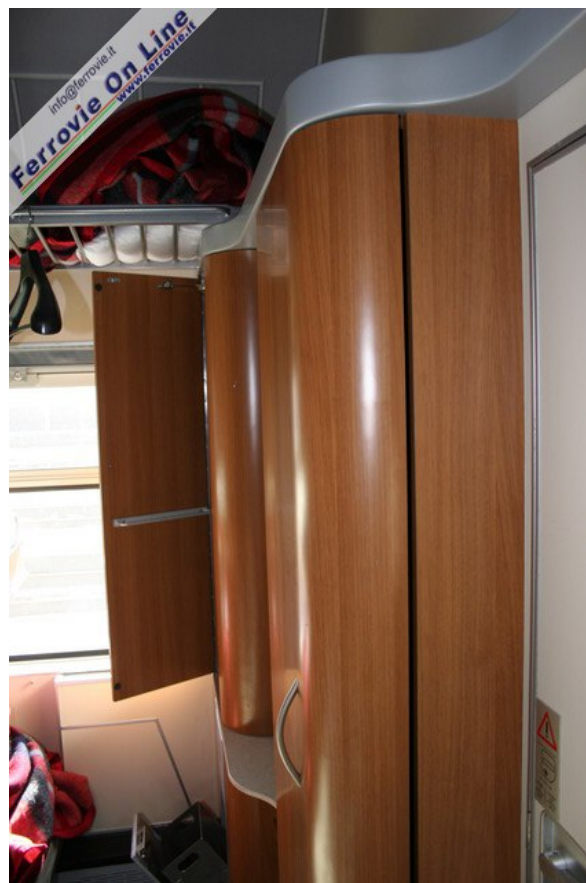
2. Interni della carrozza letti MU rinnovata. In cabina il nuovo armadietto che ospita lavabo, portasciugamani, porta bicchieri, specchio e prese di corrente. (Foto David Campione, 8 novembre 2006)
