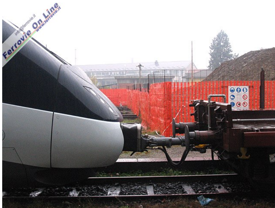
3 Un particolare del gancio dell'IC4 unito alla barra rigida montata sul carro pianale. Foto Guido Catasta, 25 novembre 2006
