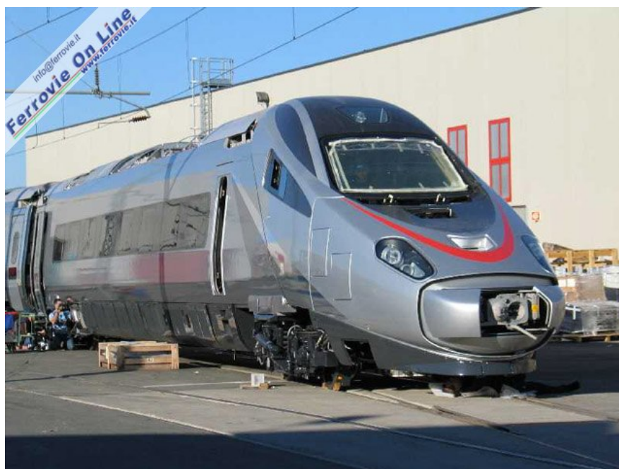
Il secondo ETR.600 per Trenitalia, in completamento presso l'ALSTOM di Savigliano.
