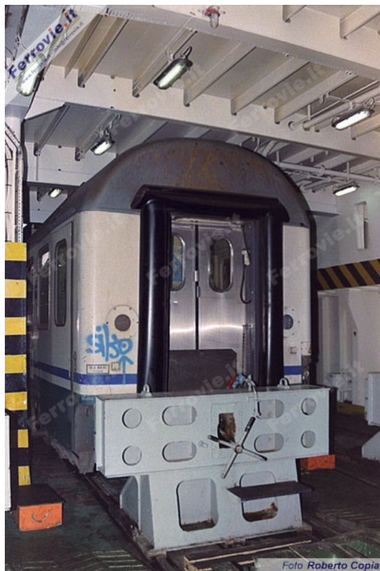
4. Vettura tipo Z di seconda classe in composizione all'IC Archimede al paraurti della nave Scilla, dotato di maglia di aggancio e presa di aria compressa per la frenatura del convoglio. (Foto Roberto Copia, 4 luglio 2003)
