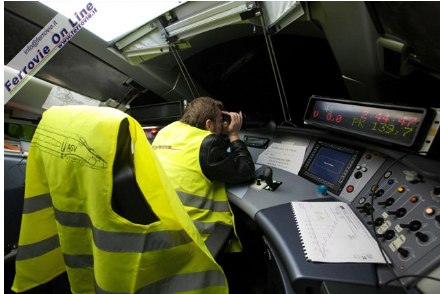
L'ampia cabina dell'AGV con il banco di manovra ed il posto di guida in posizione centrale. Foto Alstom, 29 novembre 2008
