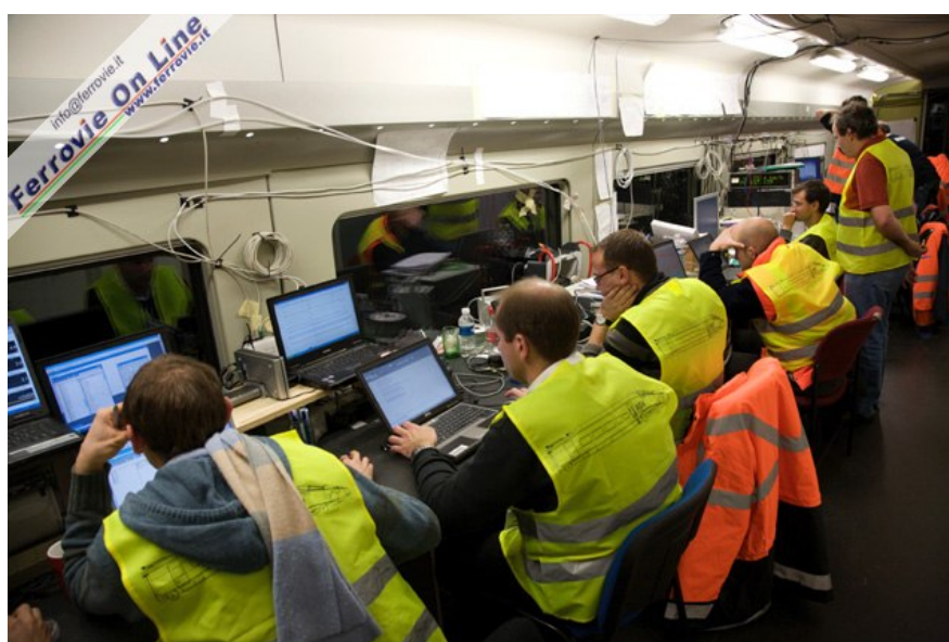
2 2 Interno dell'AGV, allestito per le misurazioni durante le prove in linea. (Foto Alstom, 29 novembre 2008)
