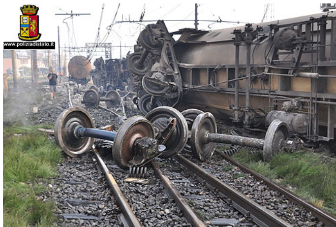
2, Quello che resta del carro cisterna deragliato con la conseguente uscita di GPL a cui è seguita la violenta esplosione (Foto Polizia di Stato, 30 giugno 2009)
