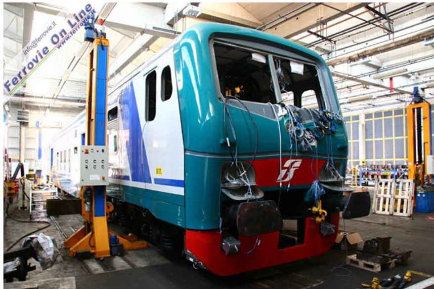
4. Carrozza pilota in allestimento, ancora equipaggiata con i due respingenti tradizionali, che verranno sostituiti con organi di repulsione idonei per l'aggancio automatico. (Foto David Campione, 14 luglio 2009)
