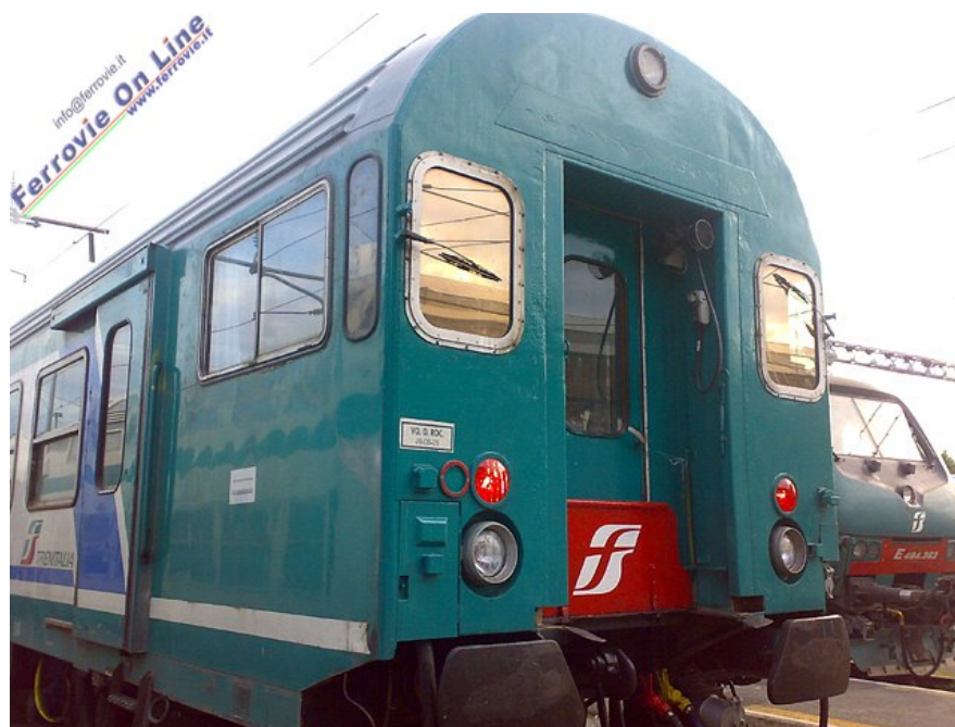
Testata della carrozza pilota passante per Medie Distanze 82-86 846 nPBDH, priva dei mantici intercomunicanti tubolari. Foto Maurizio Di Gravo, 18 settembre 2009
