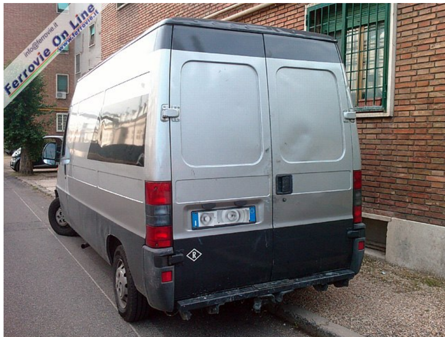
33 Retro del furgone, con losanga e lettera "R" ad indicare la presenza di freno in categoria "R" (Foto David Campione, 24 settembre 2009)
