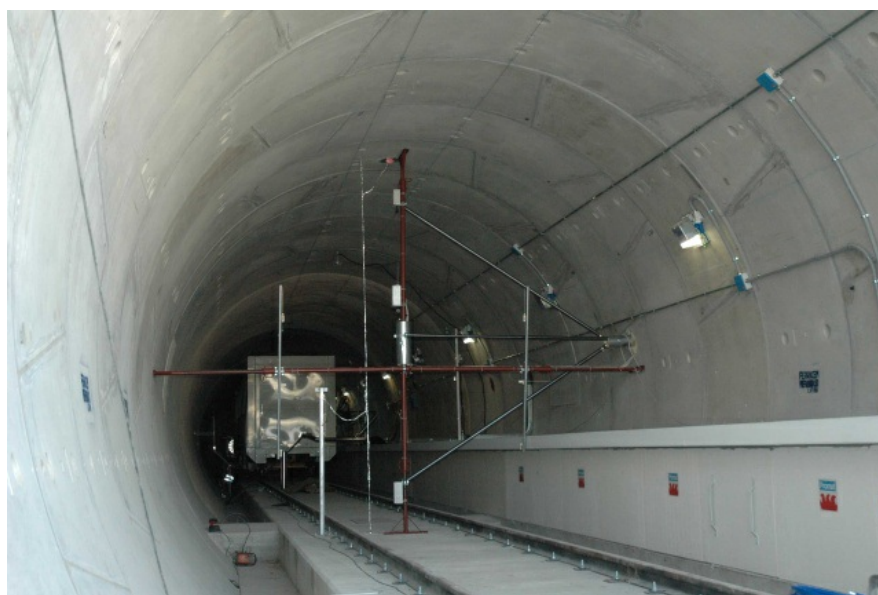
La galleria della Metro C di Roma ricostruita presso la Scuola di formazione operativa dei Vigili del fuoco per testare gli effetti di un incendio. (Foto Vigili del Fuoco)
