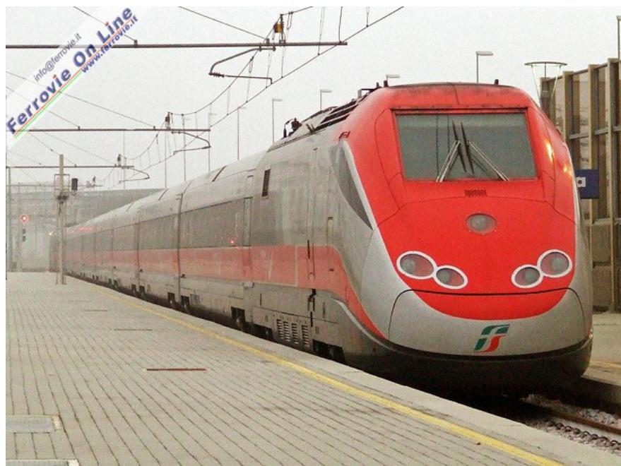
**1. L'ETR.500 n. 59, protagonista delle corse prova a 200 km/h su linea attrezzata con Blocco Conta Assi e codici Infill, sosta sul primo binario della stazione di Nogara. (Foto Andrea De Berti, 18 novembre 2009)**
