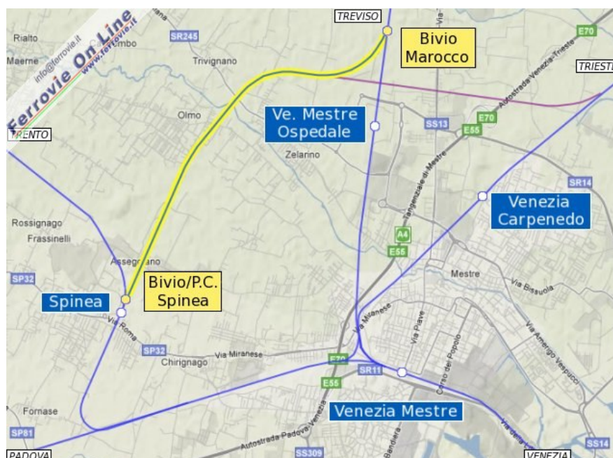
1. Mappa della rete RFI intorno al nodo di Mestre: in giallo le nuove attivazioni, in viola il tratto dismesso dei Bivi, in blu le linee in esercizio. Disegno Davide Cester, 10 marzo 2010
