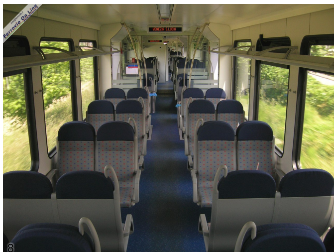
8. Vista "dall'alto" dell'ambiente interno di un FLIRT Sistemi Territoriali; si notano le ampie superfici vetrate, le bagagliere spaziose, i sedili a sbalzo e i display informativi. (Foto Davide Cester, 14 giugno 2010)
