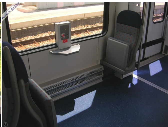
8. Vista "dall'alto" dell'ambiente interno di un FLIRT Sistemi Territoriali; si notano le ampie superfici vetrate, le bagagliere spaziose, i sedili a sbalzo e i display informativi. (Foto Davide Cester, 14 giugno 2010)
