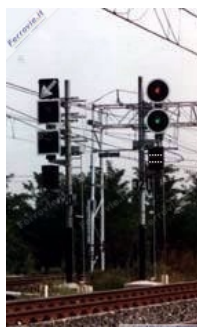
5. Rosso verde con segnalazione ausiliaria. Le strisce orizzontali luminose di colore bianco sono due, quindi: via libera con conferma di velocità a 100 e avviso di segnale successivo a via impedita. (Foto Alessandro Manfredi, 28 novembre 1997)
