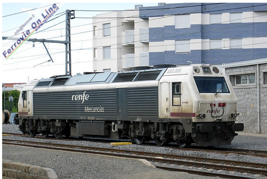
Locomotiva Diesel-elettrica 333.355 di Renfe Mercancías, potente macchina da 1875 kW e 160 km/h, in sosta ad Avila. (Foto Jacopo Fioravanti, 03 luglio 2009)
