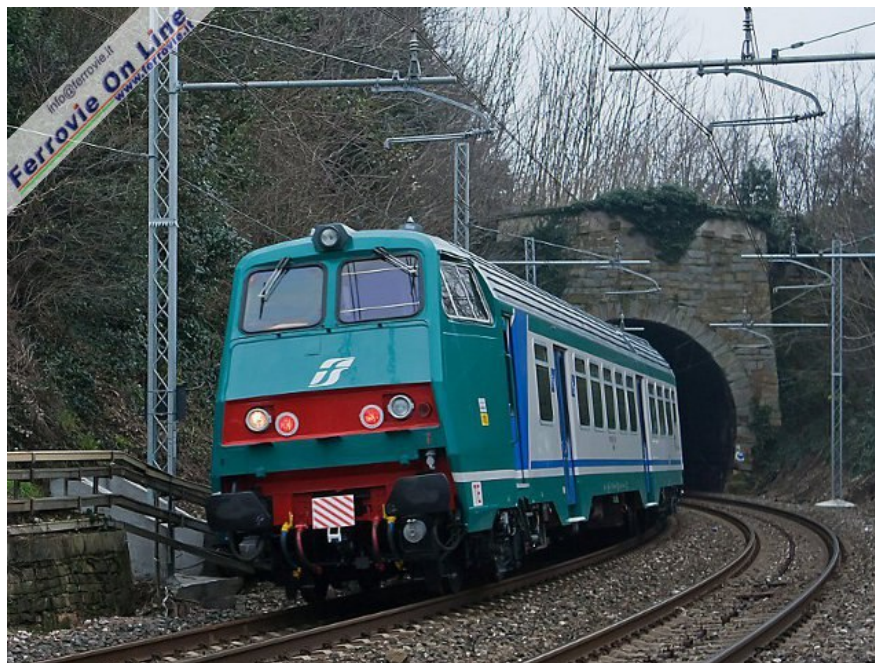
3. In coda al convoglio, la pilota MD ristrutturata. Si nota l'eliminazione del piccolo fanale verde, il cui utilizzo non è più previsto dal regolamento segnali. (Foto Michele Piemonte, 15 febbraio 2011)
