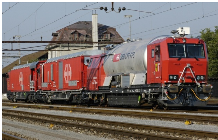
Il treno di salvamento e spegnimento delle Ferrovie Federali Svizzere impegnato all'interno del traforo del Sempione dopo l'incendio a un treno merci. (Foto FFS)
