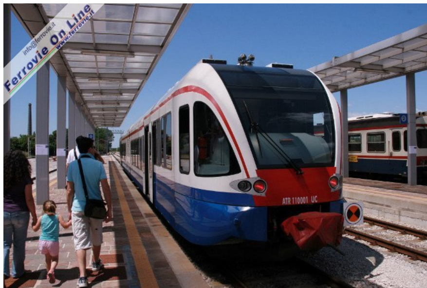
4. Uno dei nuovi convogli Stadler GTW diesel a due elementi, parte di un ordine comune effettuato nel 2006 insieme alla veneta Sistemi Territoriali. Foto Federico Gitto, 25 giugno 2011
