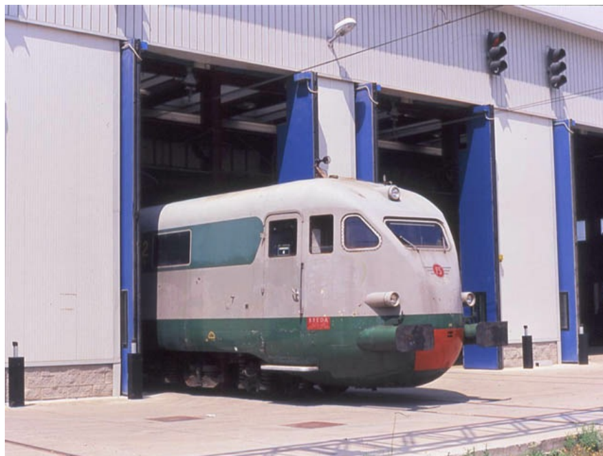
3 L'ETR.232 fa capolino da uno dei portoni dell'officina di Firenze Osmannoro dove si sono svolti i controlli tecnici al sottocassa. Foto Pietro Forconi, 20 luglio 2005
