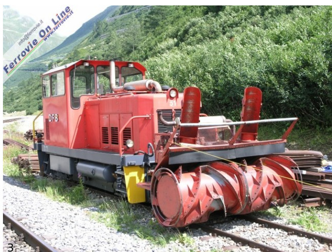
3. Nella stazione di Gletsch molti i mezzi esposti e aperti al pubblico. Nell'immagine una fresa spazzaneve utilizzata per permettere il transito sulla tratta anche nei duri inverni. (Foto Davide Zamboni, 13 agosto 2010)
