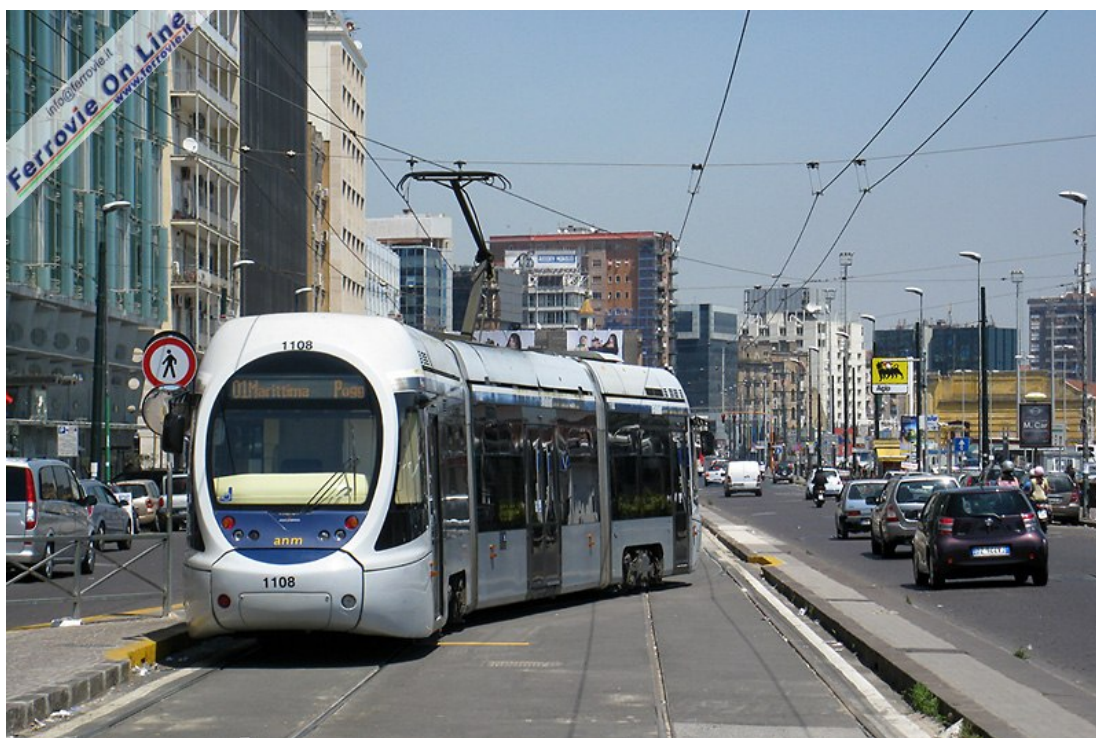
1. Vettura tramviaria 1108 di ANM - un Sirio AnsaldoBreda a 3 casse - in partenza dal capolinea provvisorio della linea 1 in via Cristoforo Colombo, presso la Stazione Marittima. (Foto Jacopo Fioravanti, 12 maggio 2012)
