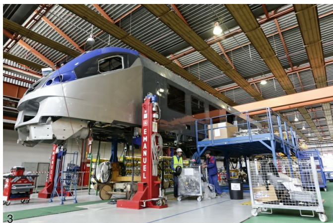
3. Linea di produzione dei nuovi treni, nello stabilimento Alstom di Savigliano. (Foto Alstom)
