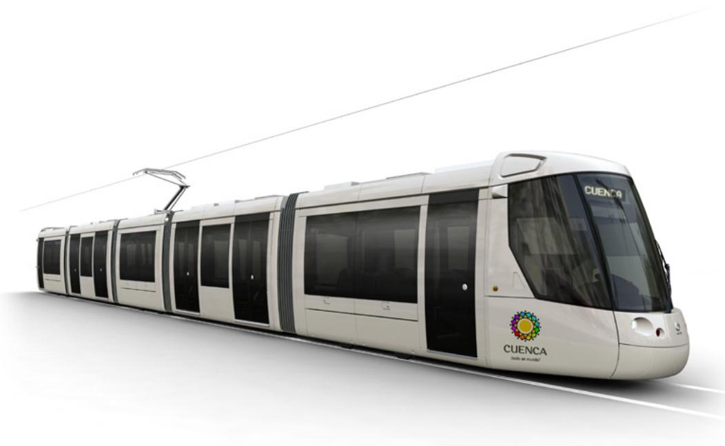
**Il tram Citadis con alimentazione da terza rotaia con sistema APS e catenaria, da Alstom per la città di Cuenca in Ecuador. (Disegno Alstom)**
