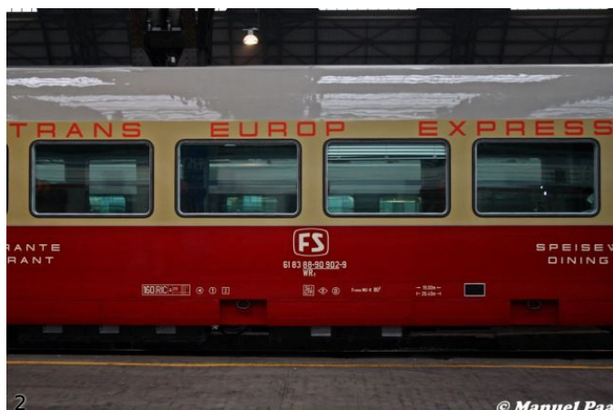
2. Particolare del centro della carrozza, con l'inconfondibile scritta "Trans Europ Express". Circostanza particolare l'indicazione di velocità massima 160 km/h, nonostante gli smorzatori dei moti di serpeggio sui carrelli, che consentirebbero alla vettura di raggiungere i 200 km/h. (Foto Manuel Paa, 22 ottobre 2013)
