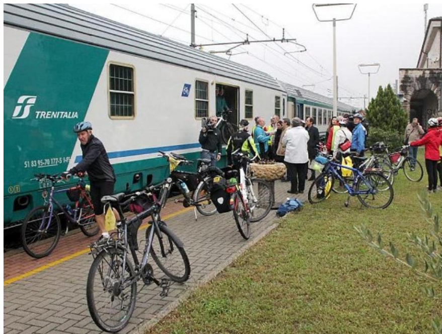
3. Uno dei nuovi bagagliai nel suo primo turno di servizio con gli Amici della Bicicletta. Porta la marcatura 51 83 95-70 177-5 I-FS ed è del tipo UIC-X; fa parte di una serie di 80 ordinati nel 1987 e realizzati nel 1989-91, attrezzati per i treni navetta. In origine avevano ritirata, scompartimento per il capotreno e due comparti bagagli. Alcuni della stessa serie sono equipaggiati di stufe e si usano tuttora per i treni pellegrini (Foto L'Arena, 06 ottobre 2013)
