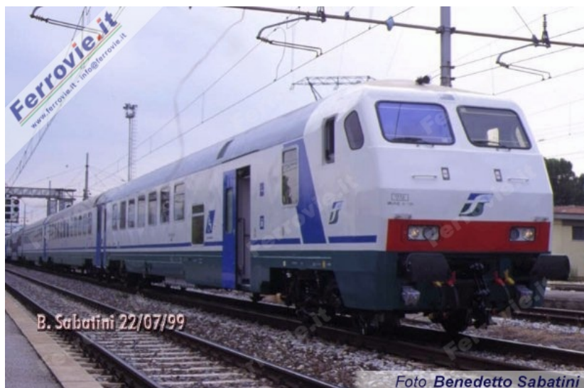
Carrozza pilota tipo X a Firenze Cascine, durante la prima corsa prova per la valutazione del peso frenato. (Foto Benedetto Sabatini, 22 luglio 1999)
