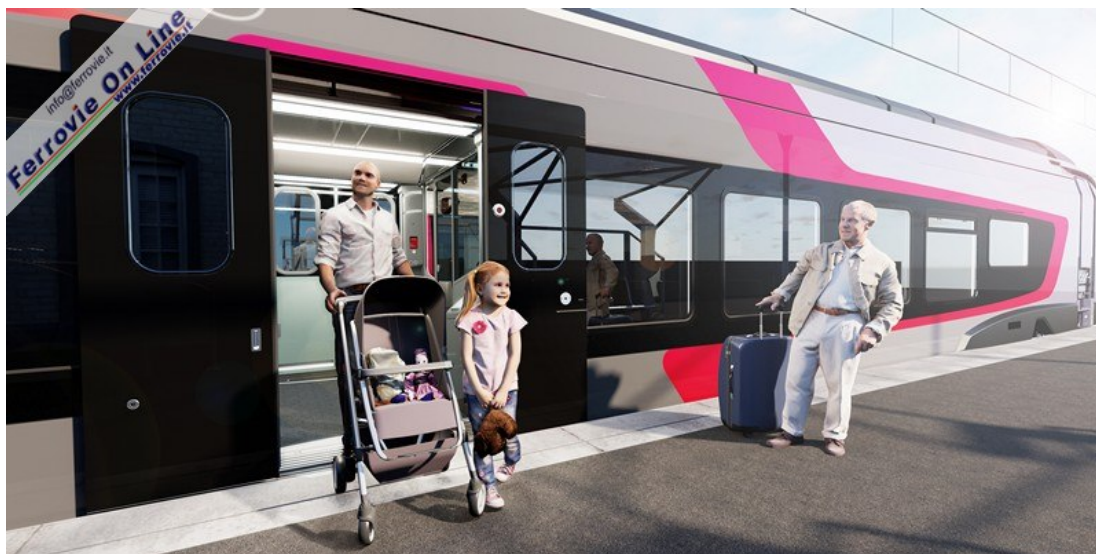
2 Il V200 disporrà di accesso a raso sui marciapiedi alti, con doppie porte per un imbarco più agevole. (Disegno Alstom)
