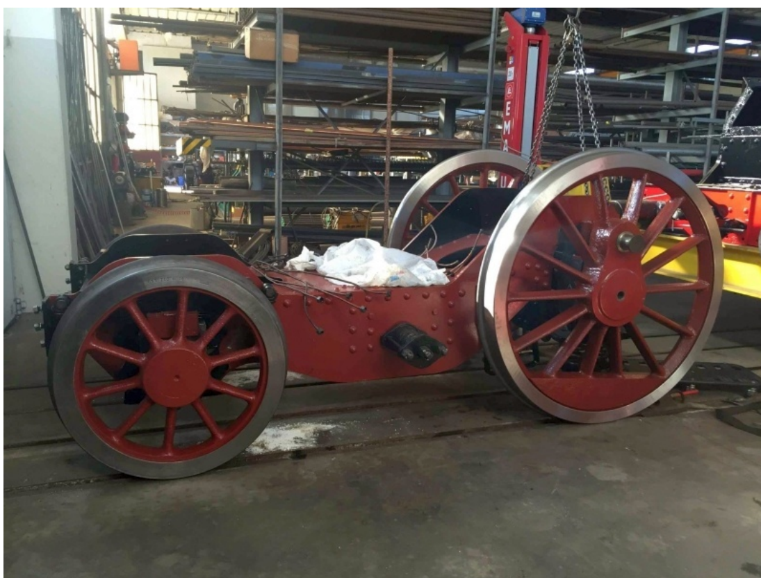
1. Carrello italiano con l'asse portante anteriore ed il primo asse accoppiato. (Foto Lucato Termica)
