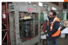
Compression d'un tampon à la presse hydraulique pour désolidariser ses éléments
