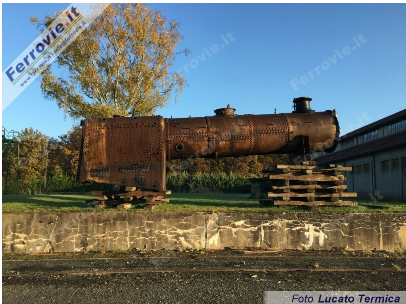
22 La caldaia della 230 G 353 in attesa della riparazione che avverrà presso la Lucato Termica ( Foto Lucato Termica )
