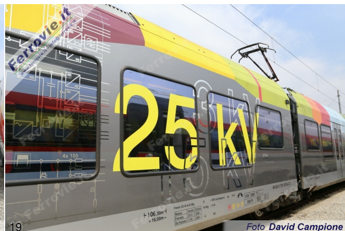
19. La vistosa scritta sulla fiancata dell'ETR.170, ad indicare la trasformazione del treno per viaggiare sotto i 25 kV in corrente alternata e su linee attrezzate con ERTMS. (Foto David Campione, 30 maggio 2016)
