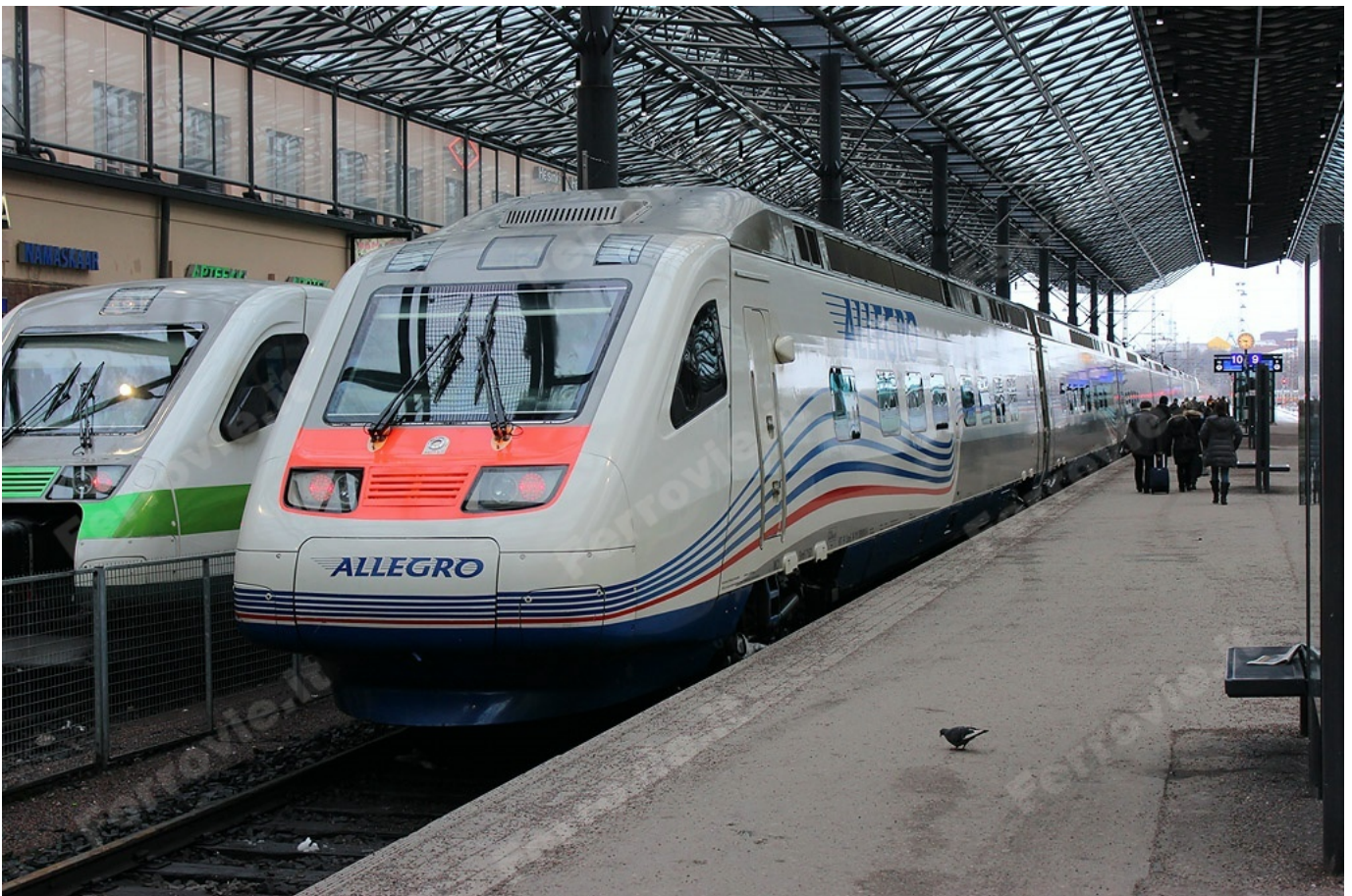
5. Al binario 10 è pronto l'Allegro 784 per San Pietroburgo, in Russia, effettuato dall'elettrotreno bicorrente Sm6 numero 2, costruito da Alstom a Savigliano nel 2009. Grazie all'assetto variabile, all'adeguamento di estese tratte della linea ad una velocità massima di 200 km/h e ai controlli di frontiera in corsa, la distanza di circa 400 km fra le due città è coperta in poco meno di tre ore e mezza. Il treno è di proprietà di Karelian Trains, società posseduta al 50% dalle Ferrovie Finlandesi (VR) e al 50% dalle Ferrovie Russe (RZD) (Foto Jacopo Fioravanti, 22 febbraio 2016)
