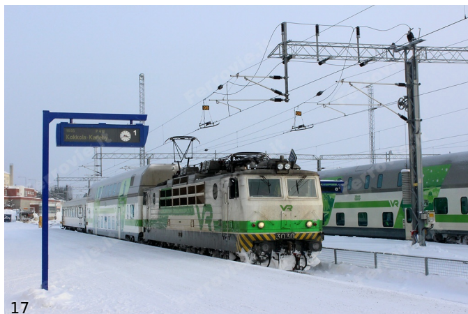
17. Pronta al binario 1 la leggera composizione dell'espresso 410 delle 16:05 per Kokkola, composta da una vettura IC2 Eco class e da una tradizionale "carrozza blu" mista di Eco class e bagagliaio, nel quale è possibile sistemare anche biciclette e animali da compagnia nel trasportino, affidate alla rocciosa Sr1 3030. (Foto Jacopo Fioravanti, 23 febbraio 2016)
