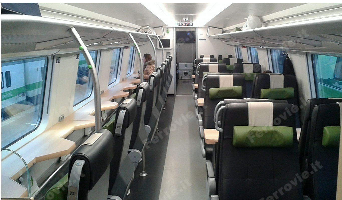
8. L'originale configurazione del piano superiore delle carrozze IC2 "Duetto Plus", con moduli tradizionali vis-à-vis a quattro posti e poltrone girevoli singole affacciate frontalmente ai finestrini. Oltre la paretina visibile in fondo si trova un inedito ambiente "conferenza" a dodici posti, venduti anche singolarmente. (Foto Jacopo Fioravanti, 22 febbraio 2016)
