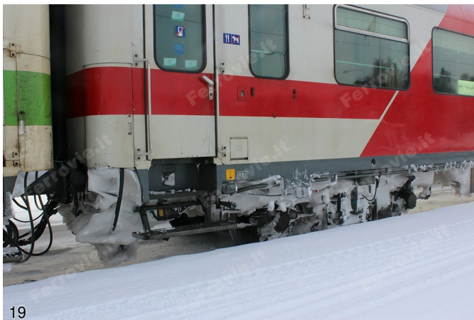
19. Importanti incrostazioni di ghiaccio e neve nel sottocassa e sui carrelli non impediscono ai treni finlandesi di funzionare normalmente. Si noti anche la presenza di maniglie e mancorrenti esterni, che l'impresa ferroviaria e le autorità locali non considerano evidentemente un rischio per l'incolumità degli utenti. (Foto Jacopo Fioravanti, 23 febbraio 2016)
