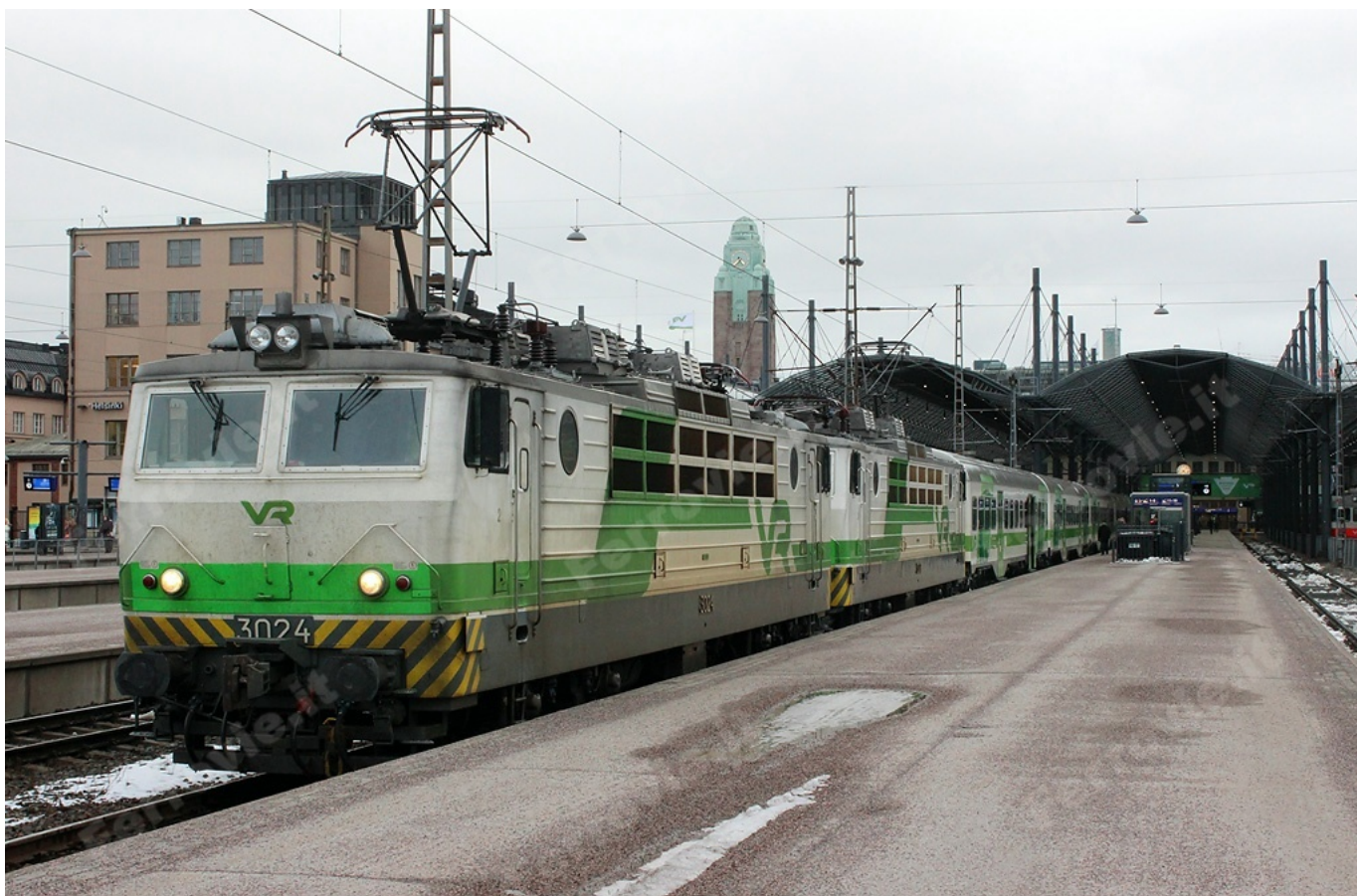
14. Doppia trazione di locomotive Sr1 per il treno regionale per Kouvola delle 16:41, composto da vetture a vestiboli paracentrali di concezione simile alle nostre MDVC, delle quali sono anche coetanee. (Foto Jacopo Fioravanti, 25 febbraio 2016)
