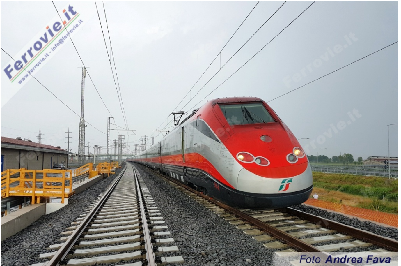
22-L'ETR.500 n.50 impegnato con i test del segnalamento sulla Treviglio - Brescia, presso il Posto Tecnologico Treviglio. Foto Andrea Fava, 12 luglio 2016
