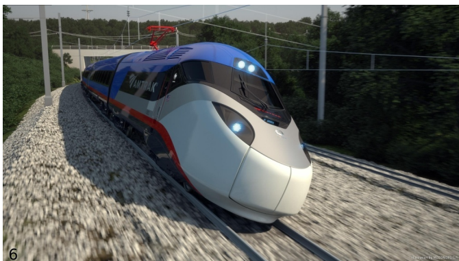
6. Rendering del treno con cassa inclinata per effetto del sistema di pendolamento. (Disegno Alstom)
