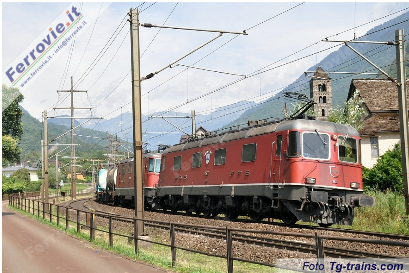
Una locomotiva Re 620 nel suo impiego abituale in doppia con una Re 420, sulla ferrovia del Gottardo. (Foto Tg-trains.com, 30 luglio 2009)
