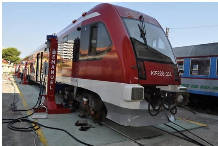
2. Un ATR.220 sui cavalletti a Bari Sud Est durante la sostituzione delle sale. (Foto FSE)
