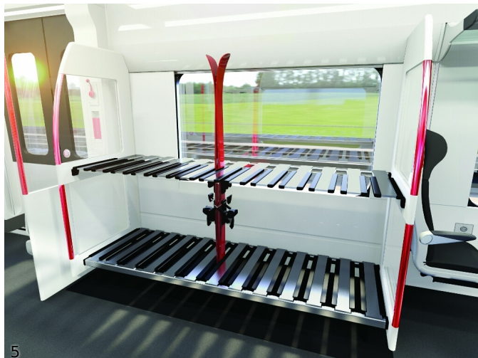
5. Esempi di interni del Coradia, con modulo porta sci... (Foto Alstom)
