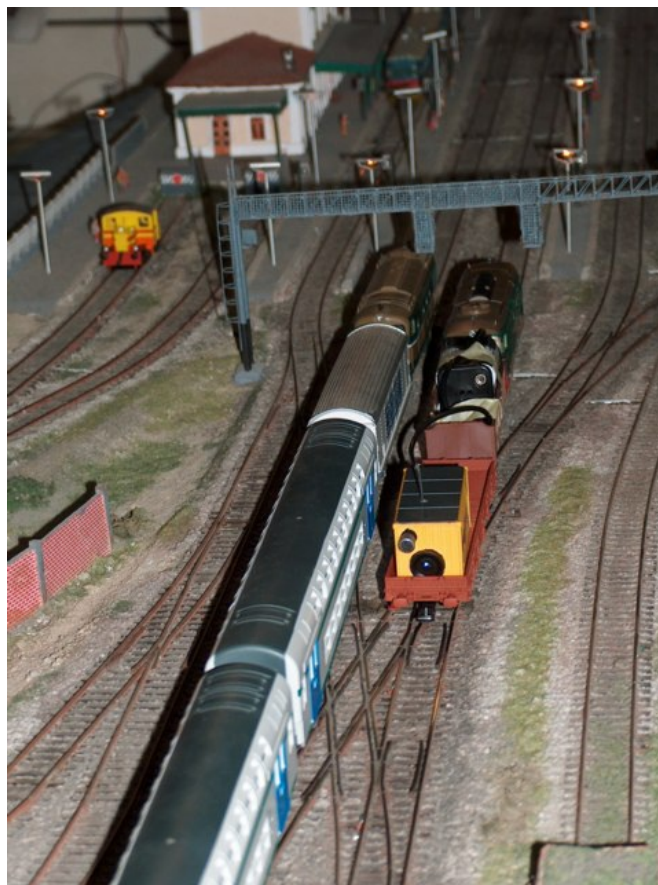
Ecco il convoglio dotato di telecamera, dissimulata in un container sistemato su un pianale. Un secondo pianale era incaricato del trasporto delle batterie, mentre alla spinta del breve convoglio troviamo una D.345. (Foto Mario De Prisco, 30 dicembre 2004)
